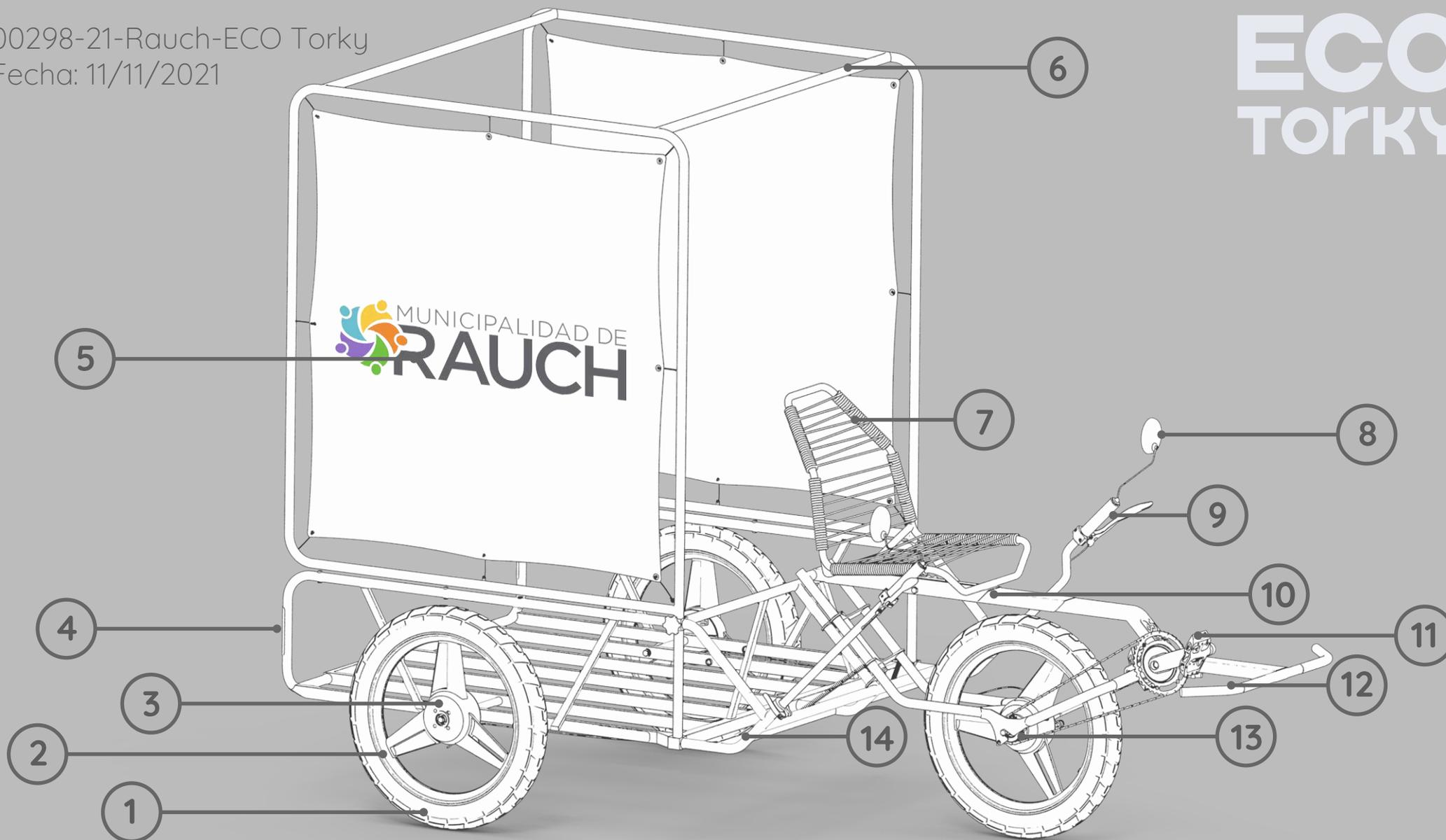
1- Cubiertas de moto 2- Llantas de aleación 3- Frenos a campana 4- Cintas reflectivas 5- Gráficas laterales 6- Estructura porta bolsón 7- Asiento ergonómico 8- Espejos retrovisores 9- Manubrios 10- Corredera de asiento 11- Conjunto plato-palancas-pedales 12- Paragolpes 13- Piñon simple 14- Portaobjetos
